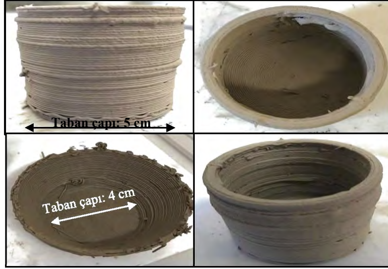
Şekil 8.37. %80 katı oranı ve kütlece %0,07 \text{CaCl}_2 tuzu içeren FFC-322 reçetesinin silindirik ( 90^\circ ) ve 60^\circ konik şekilde WASP 2040 modelli 3B yazıcıda yazımı sonrası yaş halde görünümü
