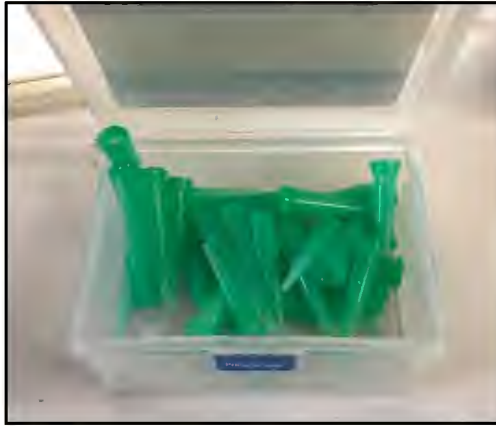
Şekil 7.4. 3 boyutlu yazımda kullanılan 0,8 mm genişliğinde plastik nozüller
