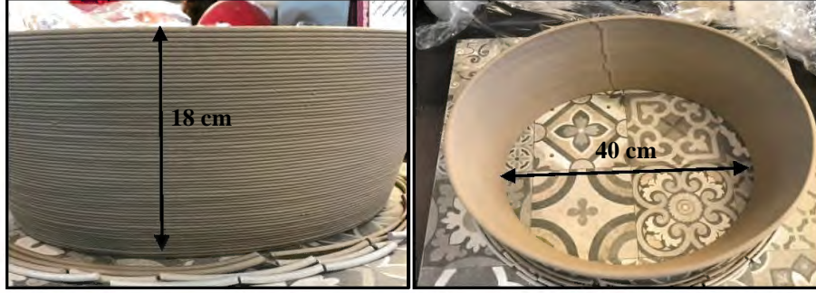
Şekil 8.38. %79 katı oranı ve kütlece %0,04 \text{CaCl}_2 tuzu içeren ince kesit reçetesinin oval şekilde WASP 2040 modelli 3B yazıcıda yazımı sonrası kuru görünümü
