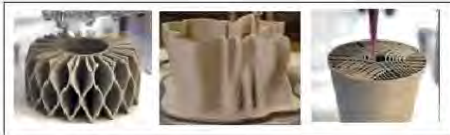
Şekil 5.5. Direk Mürekkeple Yazma ( Direct Ink Writing, Robocasting-DIW ) yöntemi ile elde edilen ürünler [21]
