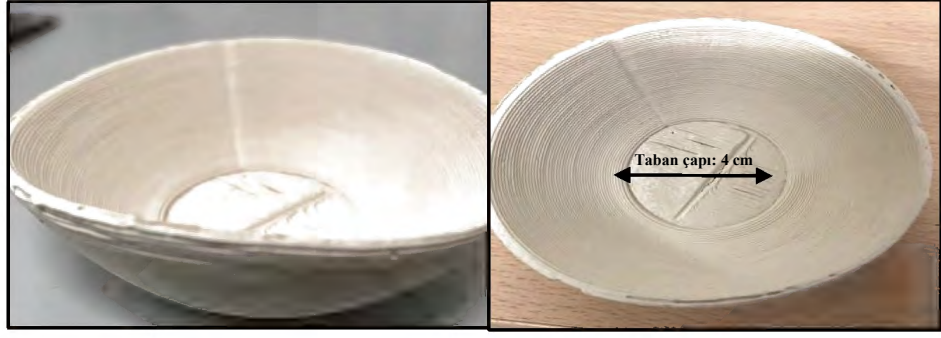
Şekil 8.33. %75 katı oranı ve kütlece %0,07 \text{CaCl}_2 tuzu içeren V9-2 reçetesinin 45^\circ konik şekilde WASP 2040 modelli 3B yazıcıda yazım sonrası pişmiş görünümü (taban çapı: 4 cm)
