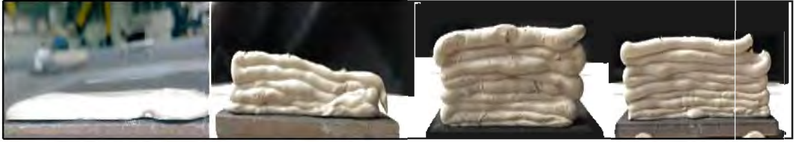
Şekil 8.24. VTİ 283 reçetesi çamurlarının sırasıyla tuz ilavesiz, %0,07 CaCl_2 , %0,09 CaCl_2 ve %0,11 CaCl_2 ilaveli yığılma görüntüleri
