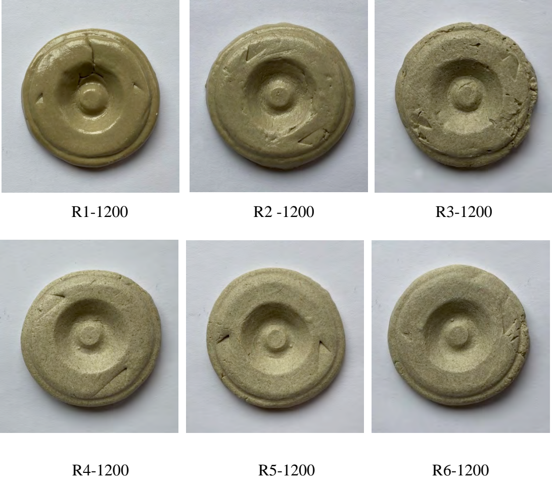
Görsel 3.5. Üçlü sistemde Profillit, Ukrayna Kili ve Feldspat ile oluşturulan bünyelerin 1200 °C'deki değişimleri
