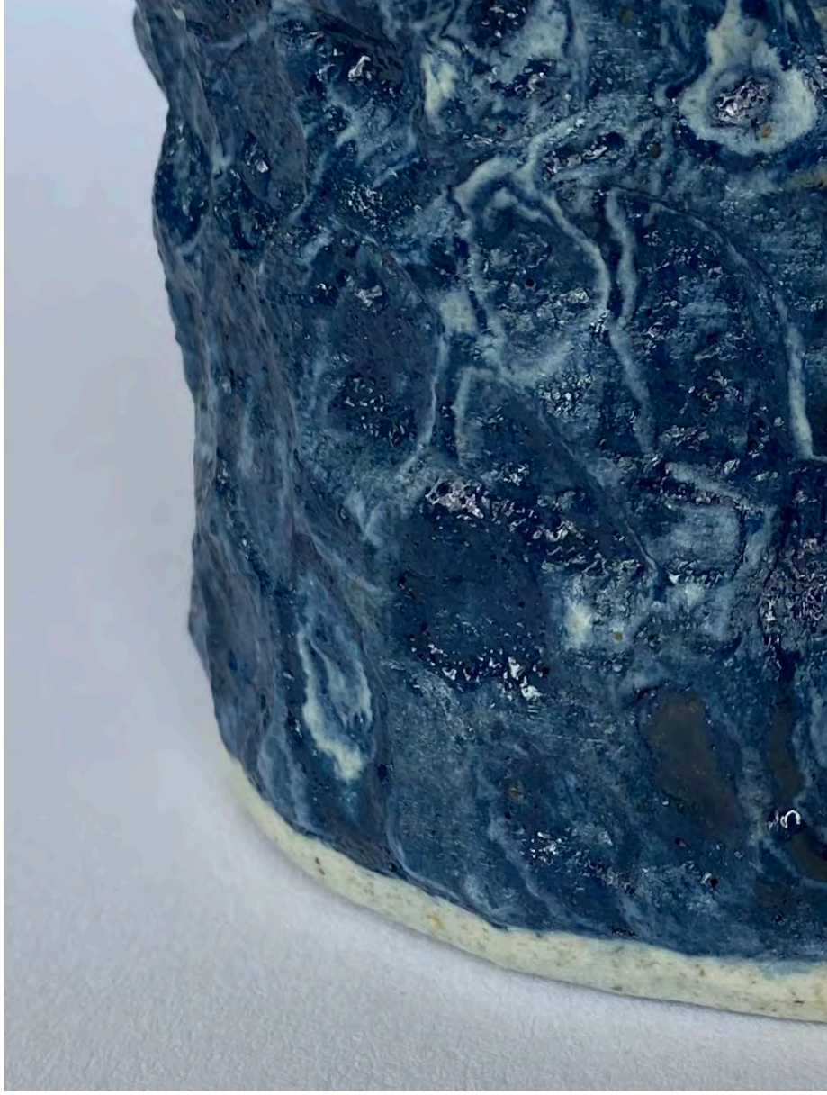
Görsel 3.27. R24 numaralı reçete ve %5 krom oksit katkılı çamur ile hazırlanmış elle şekillendirme yöntemiyle uygulanan form detayı(1280°C) 9 cm x 7,5 cm
