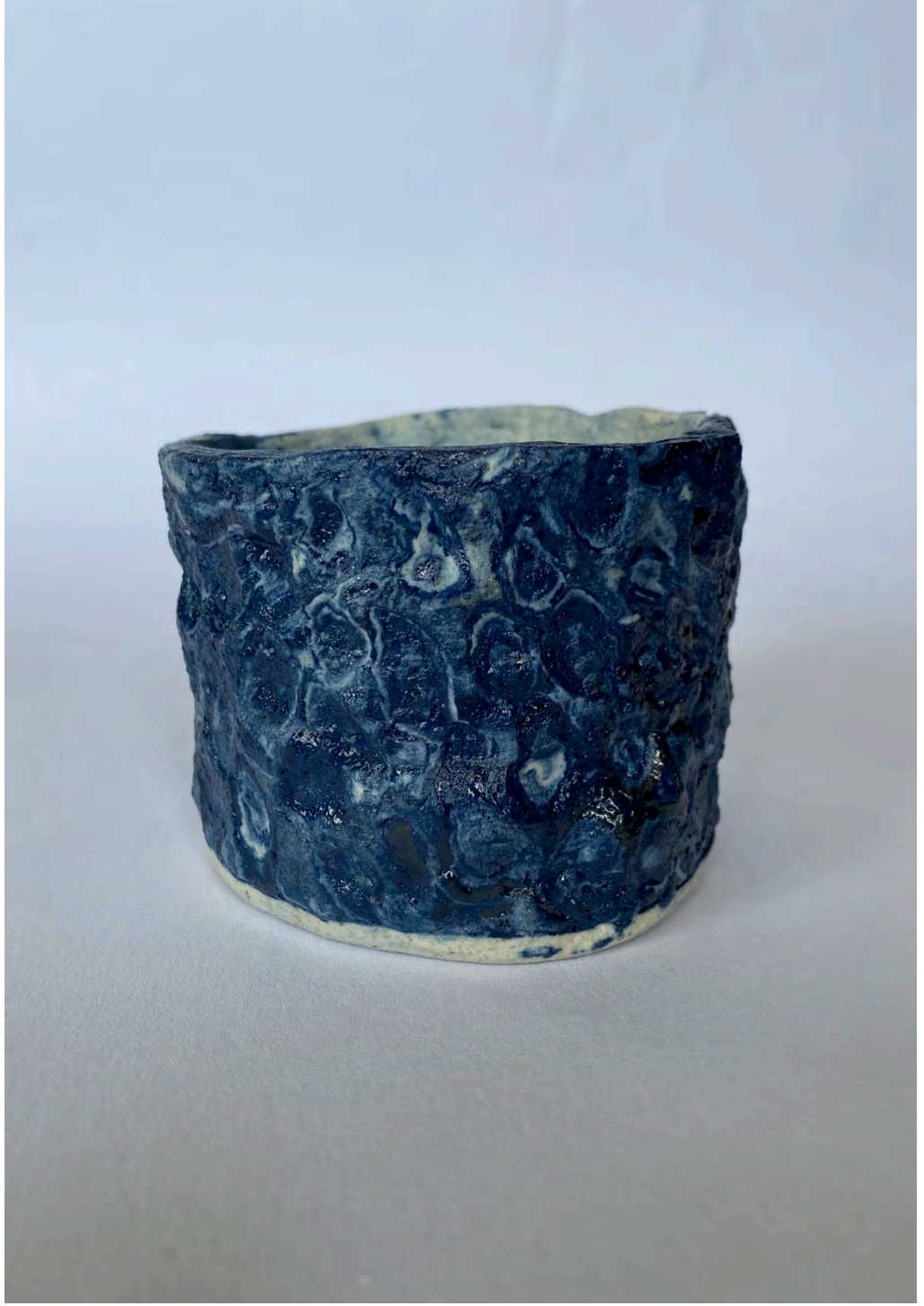
Görsel 3.26. R24 numaralı reçete ve %5 krom oksit katkılı çamur ile hazırlanmış elle şekillendirme yöntemiyle uygulanan form(1280°C) 9 cm x7,5 cm
