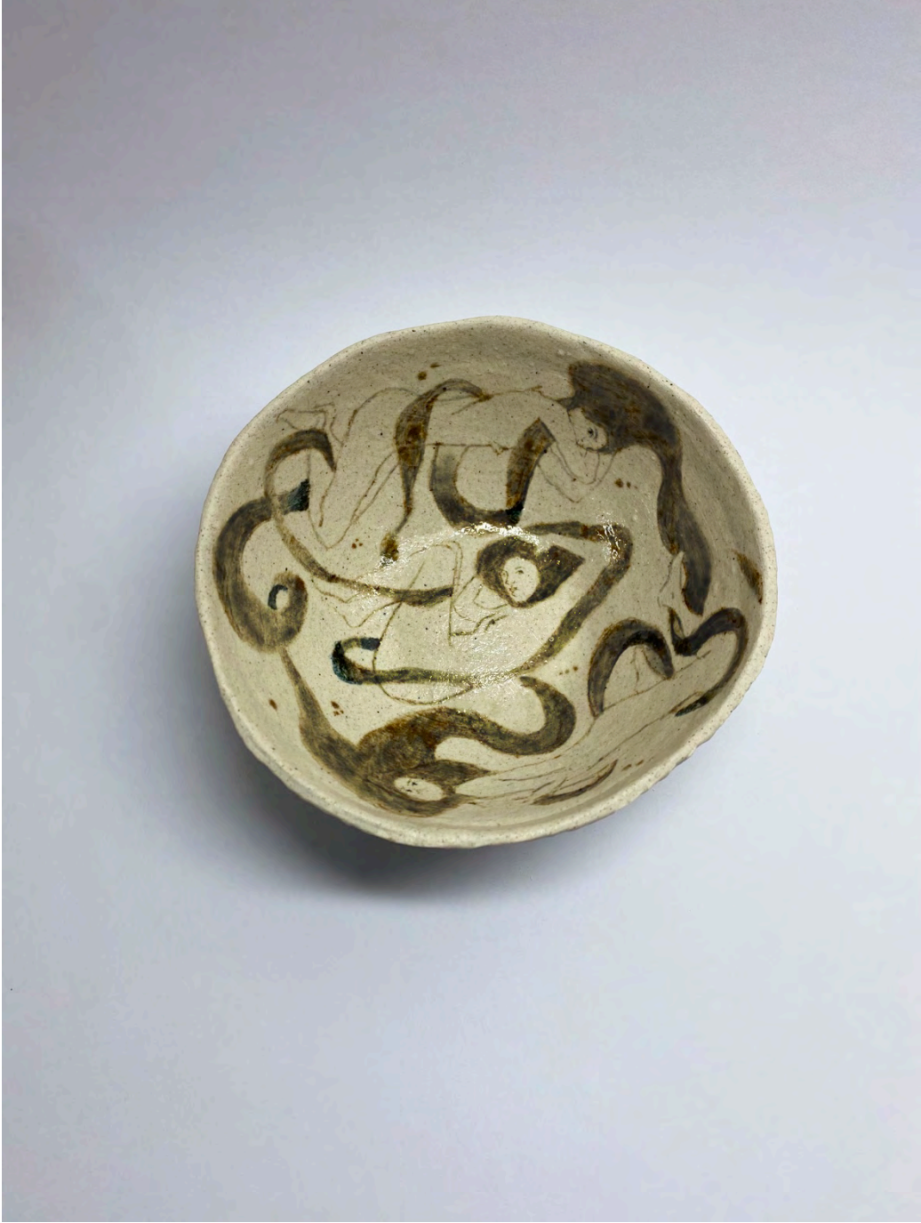
Görsel 3.28. R24 numaralı reçete ile elle şekillendirme yöntemiyle uygulanan sır altı dekor çalışması (1280°C) 17 cm x 11 cm
