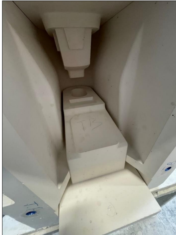
Şekil 3. 34. Rötüş işlemi tamamlanan kalıp parçalarının toplama aşaması. (M. Tolga Berkay arşivi)
