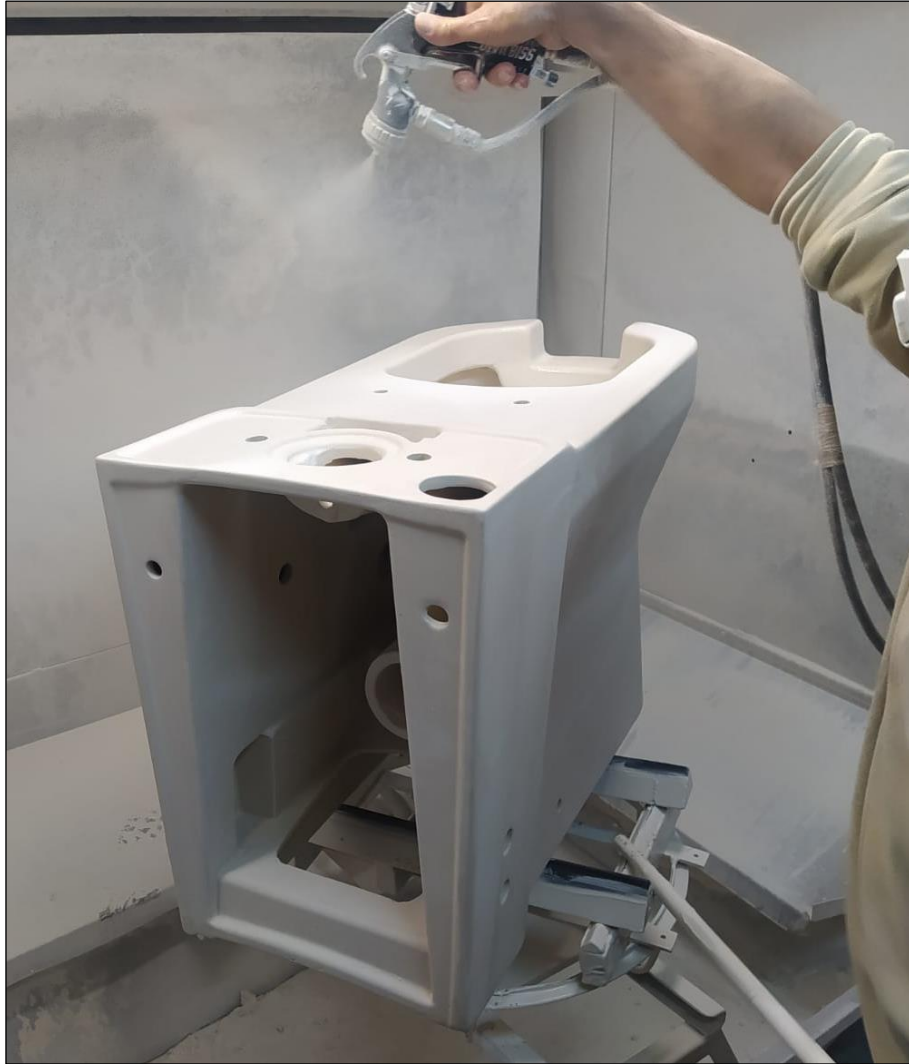
Şekil 3. 48. Pistole yardımı ile sırlama. (M. Tolga Berkay arşivi)
