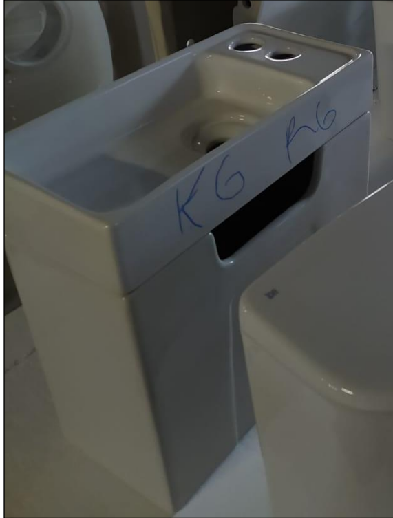
Şekil 3. 53. Fırın çıkışından pişmiş olarak çıkan, rezervuar ve lavabosu. (M. Tolga Berkay arşivi)
