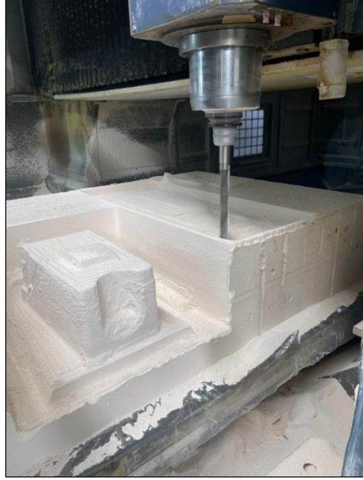
Şekil 3. 23. Klozet kalıbı için kaba boşaltma operasyonu çalışması. (M. Tolga Berkay arşivi)
