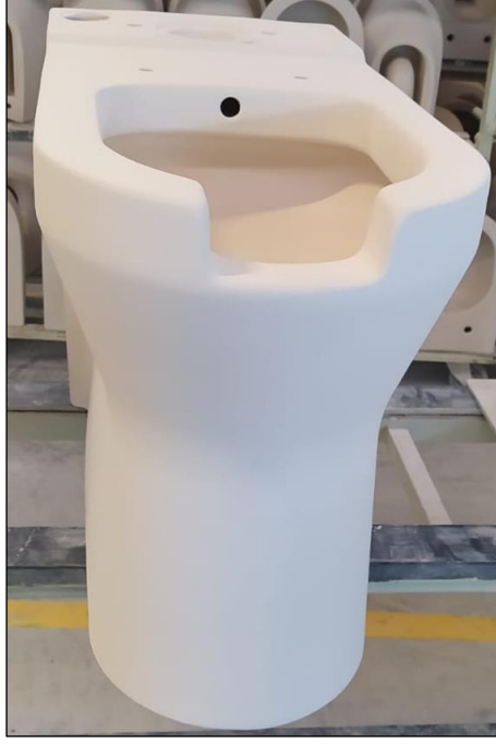
Şekil 3. 49. Sırlama işlemi tamamlanmış, bedensel engellilere ait klozet yarı mamul örneği. (M. Tolga Berkay arşivi)
