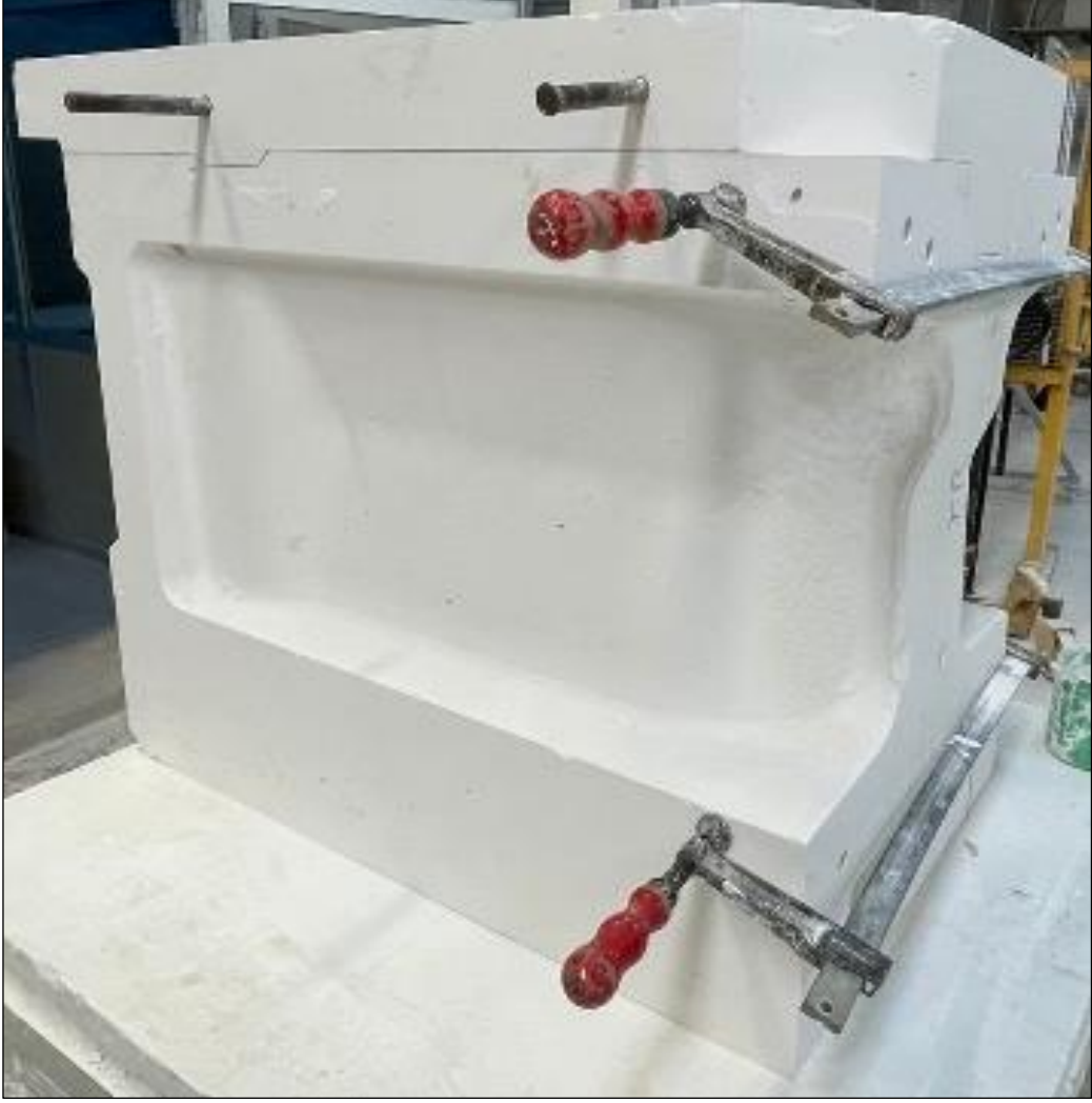
Şekil 3. 35. Rötüş işlemleri tamamlanan kalıp parçalarının toplama aşaması. (M. Tolga Berkay arşivi)
