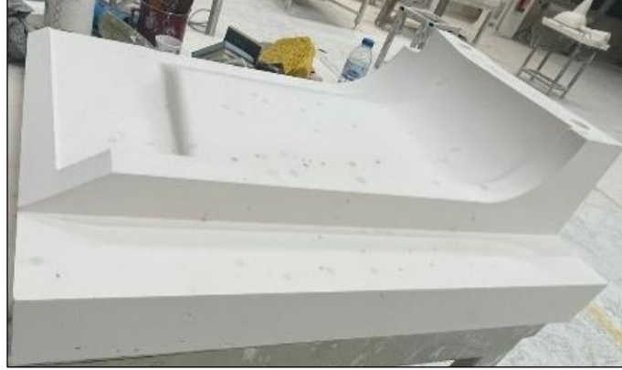
Şekil 3. 33. CNC tezgahında işlenmiş olan, klozet yan kalıp parçası. (M. Tolga Berkay arşivi)
