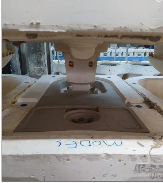
Şekil 3. 36. Belirli sertleşmesi tamamlanmış klozet kalıbının açılma aşaması. (M. Tolga Berkay arşivi)
