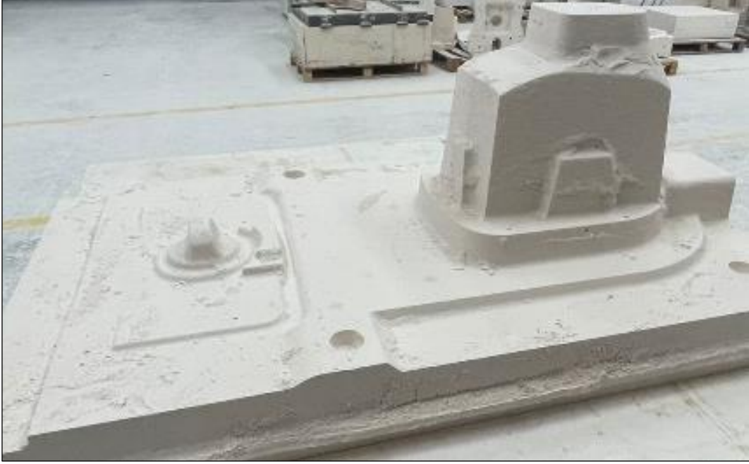
Şekil 3. 31. CNC tezgahında işlenmiş olan, klozet üst kalıp parçası. (M. Tolga Berkay arşivi)
