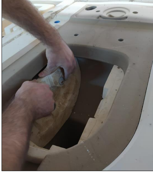
Şekil 3. 38. Klozetin hazne bölgesini oluşturan manyetik parçaların üründen çıkartılması. (M. Tolga Berkay arşivi)
