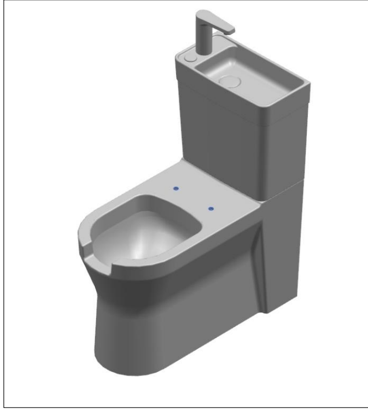
Şekil 2. 9. Kabuk tasarımı tamamlanmış olan, bedensel engelli klozetin perspektif görüntüsü. (M. Tolga Berkay arşivi)
