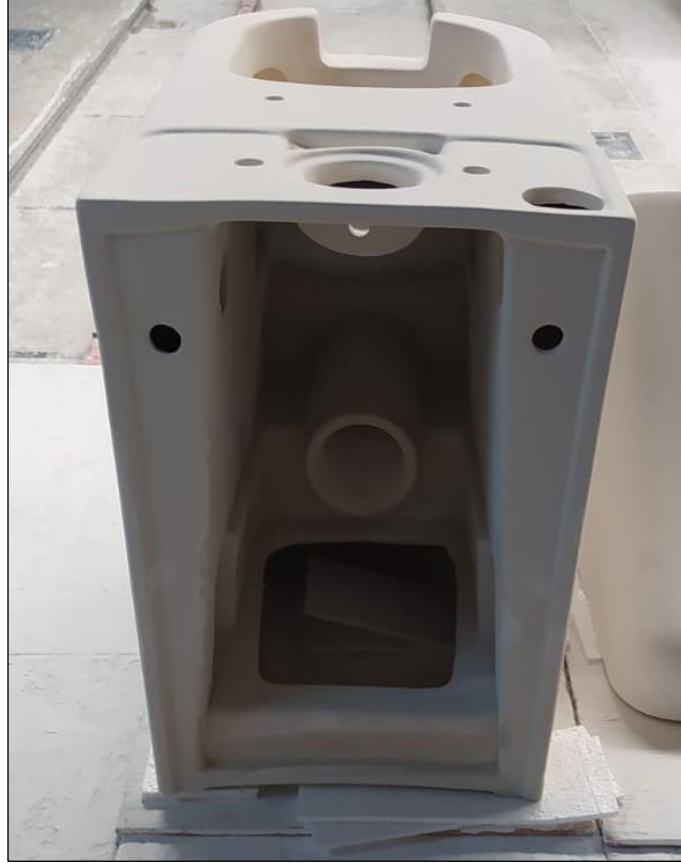
Şekil 3. 51. Sırlama işlemi tamamlanmış yarı mamulün fırın vagonuna yüklenme aşaması. (M. Tolga Berkay arşivi)
