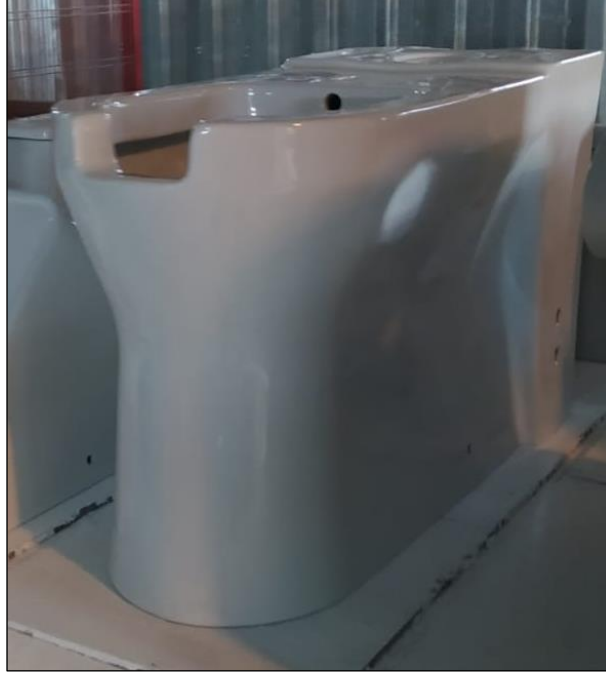
Şekil 3. 54. Fırın çıkışından pişmiş olarak çıkan, rezervuar ve lavabosu. (M. Tolga Berkay arşivi)
