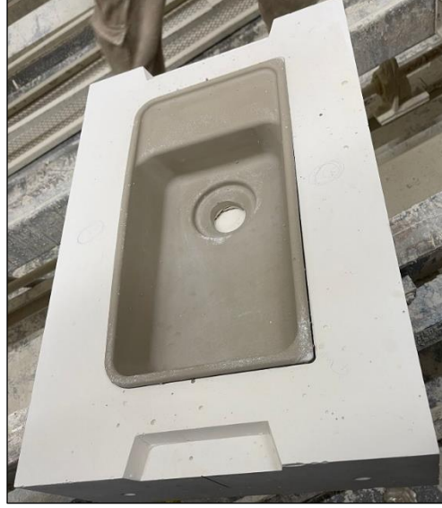
Şekil 3. 42. Belirli sertleşmesi tamamlanmış lavabonun kalıbının açılma aşaması. (M. Tolga Berkay arşivi)
