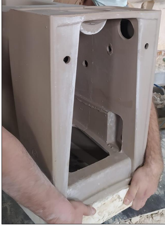
Şekil 3. 40. Klozetin kalıptan çıkartılıp tezgâha aktarılma aşaması. (M. Tolga Berkay arşivi)
