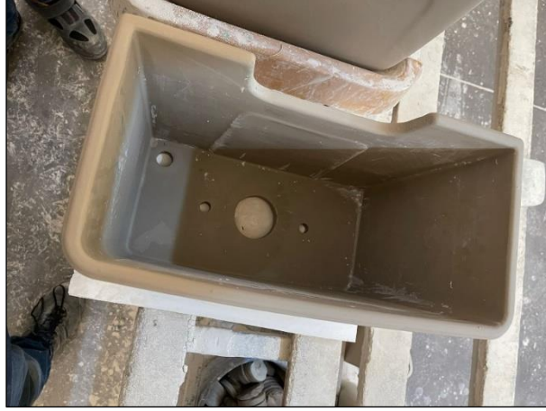
Şekil 3. 44. Rezervuarın kalıptan çıkartılıp tezgâha aktarılmış hali. (M. Tolga Berkay arşivi)
