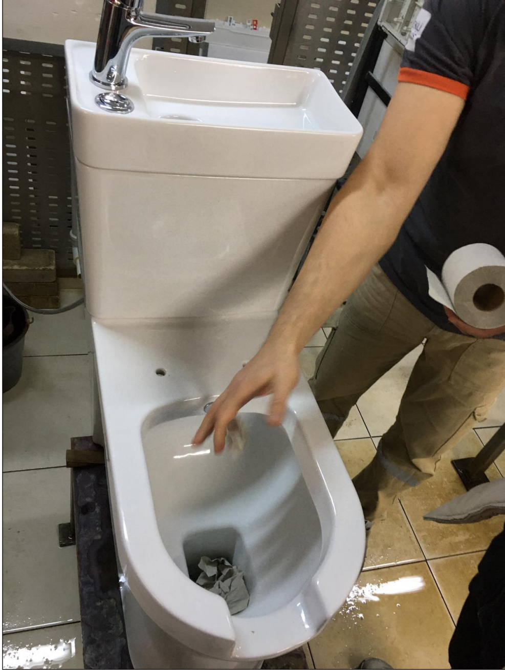
Şekil 3. 56. Klozete kâğıt testi uygulama aşaması. (M. Tolga Berkay arşivi)
