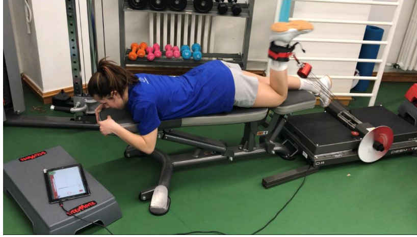
Görsel 3.13. Yatarak izoinersiyal leg curl egzersizinde konsantrik fazın sonu ve eksantrik faz başlangıcı Yatarak ve ayakta leg curl egzersizlerinde konsantrik faz sonunda diz ekleminin 90° bükülü pozisyonundan hemen sonra eksantrik fazın başlamasını sağlamak amacı ile cihazda hareket eklem açıklığı deneye özgü şekilde ayarlanmıştır.
