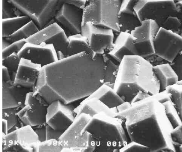
Şekil 3.3. Klinoptilolit mineralinin kristal yapısını gösteren SEM görüntüsü ( http://www.icnz.lanl.gov/Images/pictures.html )
