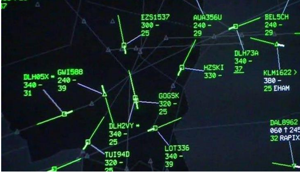
Şekil 4.5. ATC Kapsamında Saha Kontrol (ACC) Hizmetleri
