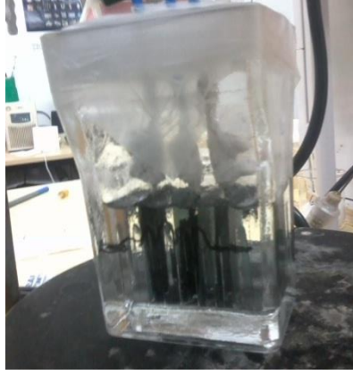
Şekil 3.4. Şarj-deşarj testleri için oluşturulmuş elektrokimyasal hücre.
