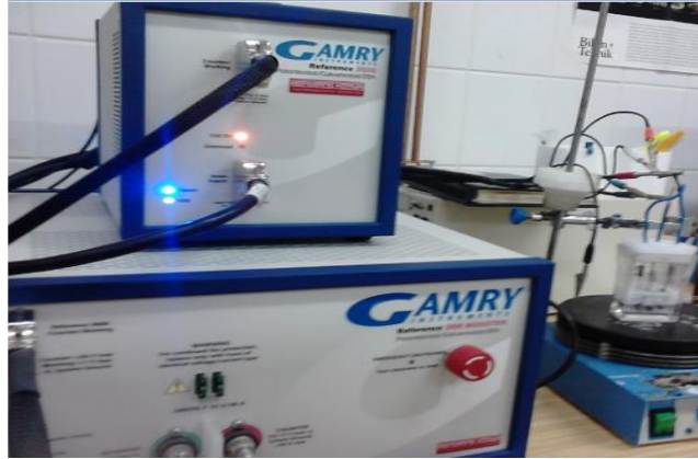
Şekil 3.2. Gamry Reference 3000 model Potentiostat/Galvanostat ZRA cihazı.
