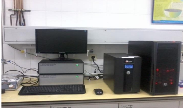
Şekil 3.1. CHI 660 D model potantiyostat/galvanostat cihazı.
