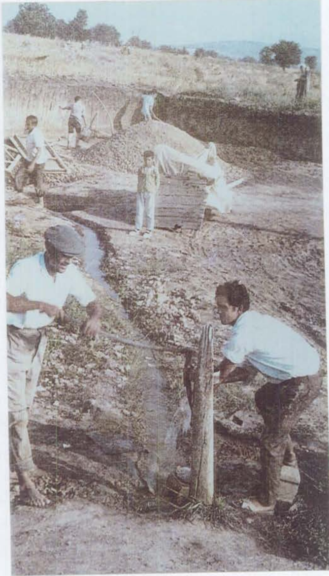
Resim 1. Kilin Alındığı Bölgede Açılan Çukurun Suyuyla Doldurulmasından Sonra Kilin Çukura Atılarak Yüzdürülmesi
