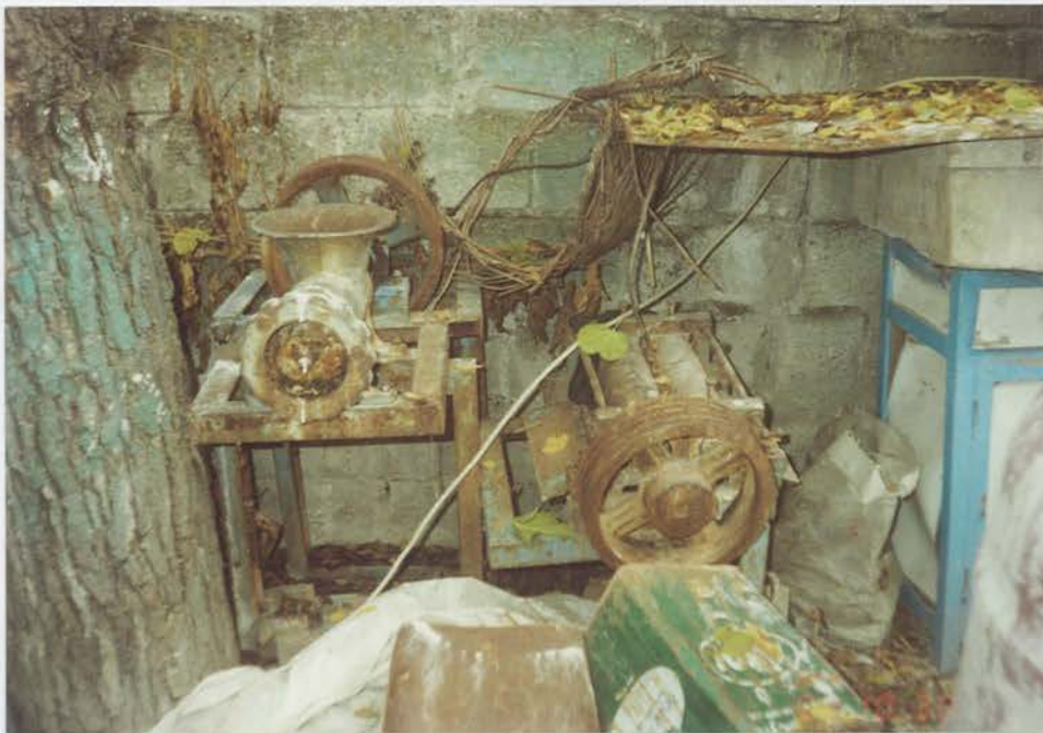
Resim 3. amur Hazırlamada Kullanılan Kıyma makinesi ve Vals
